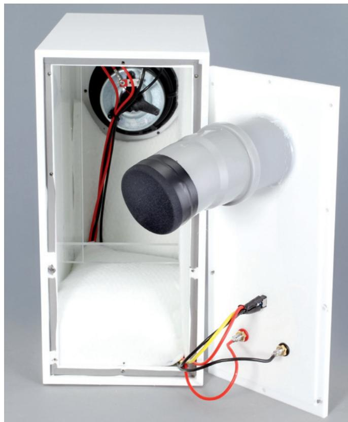
Das graue Polypropylenrohr ist mit einer Wandstärke von 3 mm stabiler als handelsübliche Bassreflexrohre. Die transparenten Acrylversteifungen bedämpfen die Resonanzen des Acrylgehäuses.
