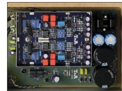
Die optionale Phonostufe lässt sich per Miniaturschalter universell anpassen.
