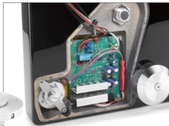
Bei der Motorsteuerung wird geklotzt. Ein Generator und vier Endstufen, in Brücke geschaltet, stehen hierfür bereit.
