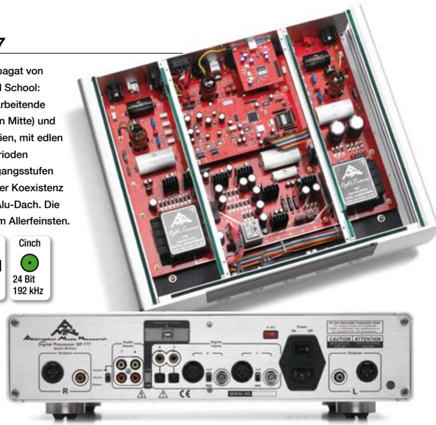
Thorsten Lösch, dass für CD-Kost die klassischen Multibit-Wandlerchips à la Philips TDA 1541 noch immer am besten klingen. Hi-Res-Wiedergabe hingegen erfordert andere Lösungen, weshalb der DP-777 gleich zwei D/A-Konverter-Systeme besitzt: Bis 88,2 Kilohertz arbeitet ein 16-Bit-Multibitwandler, darüber hinaus ein 32-Bit-Chip, der volle 192-kHz-Tauglichkeit bietet.
